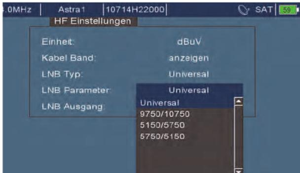
Bild 5: LNB Parameter auswählen
