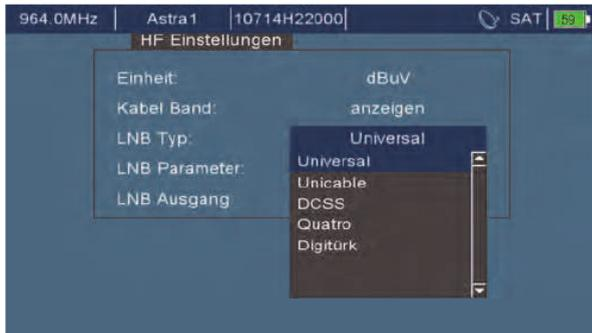
Bild 4: LNB Typ auswählen
